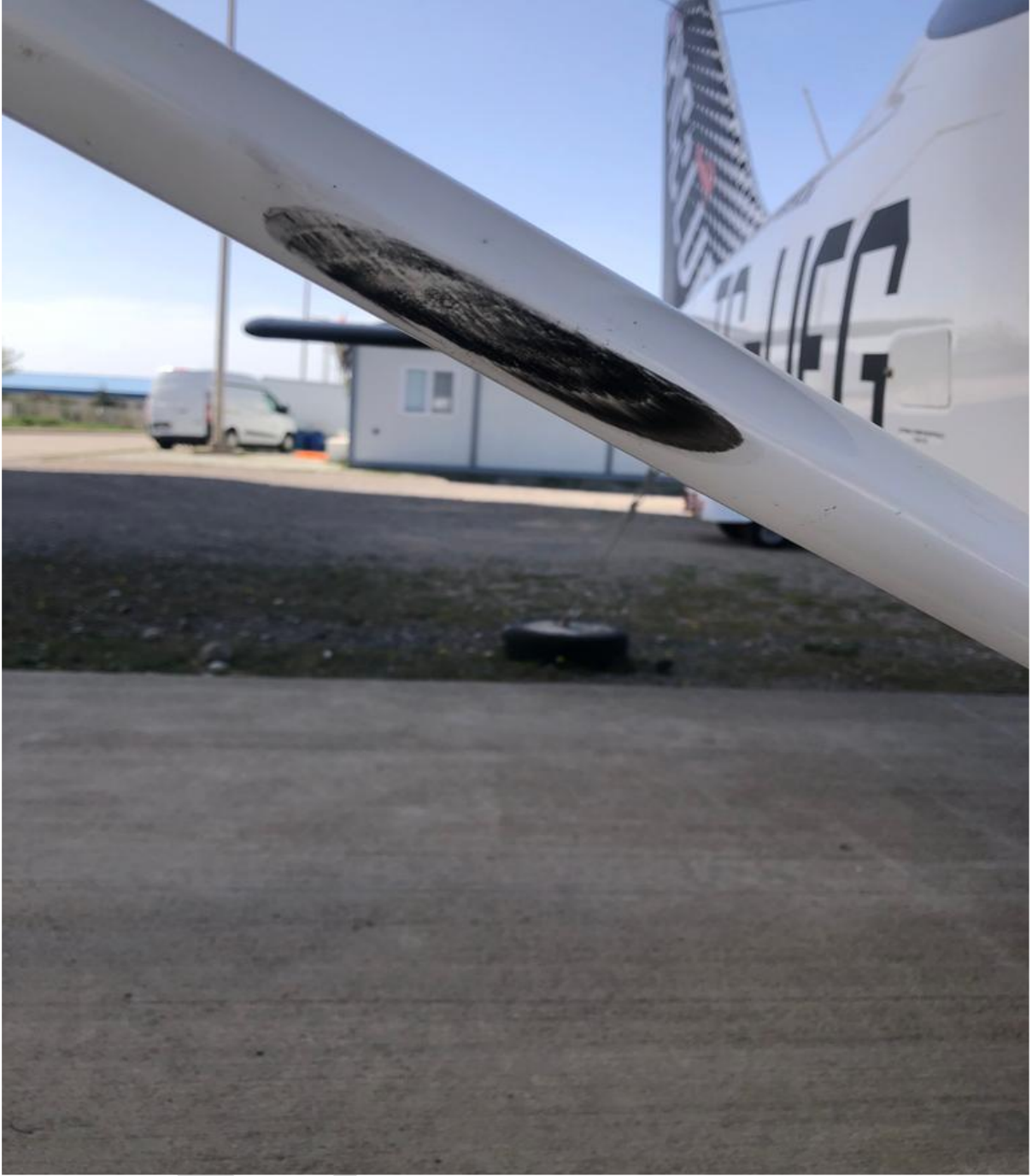
Resim-8: Sağ Strut Extrusion Cover’da Lastik İzi Hasarı
